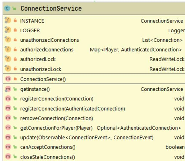
Abbildung 4: ConnectionService Klassendiagramm
